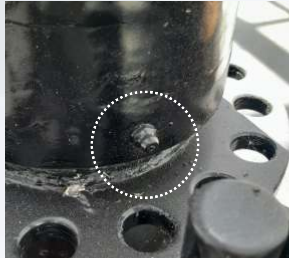
2 - Ponto de Lubrificação
