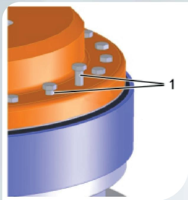
Inspeção da montagem dos parafusos
